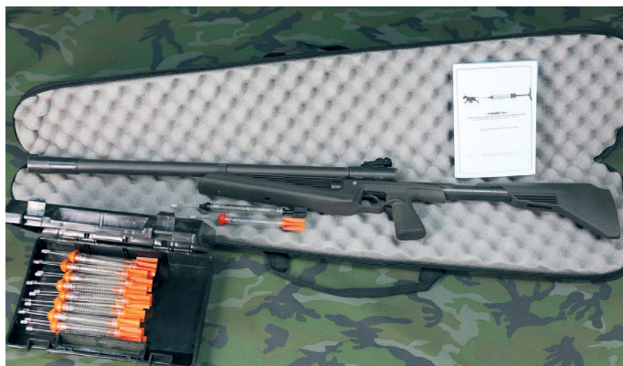
Комплект «УВЫШ-3» со шприцами от 2 до 10 мл и дальностью их полета до 100 м
