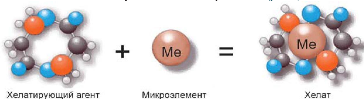
Рисунок 6 – Схема строения молекулы хелатного удобрения
